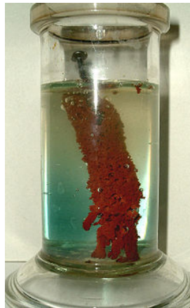
Abbildung 21 Eisenstab in Kupfersulfatlösung 14
